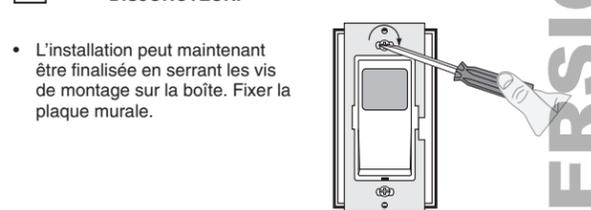
**Étape 7** **Rétablissement de l'alimentation :** Rétablir l'alimentation au fusible ou au disjoncteur. **L'installation est terminée.**
