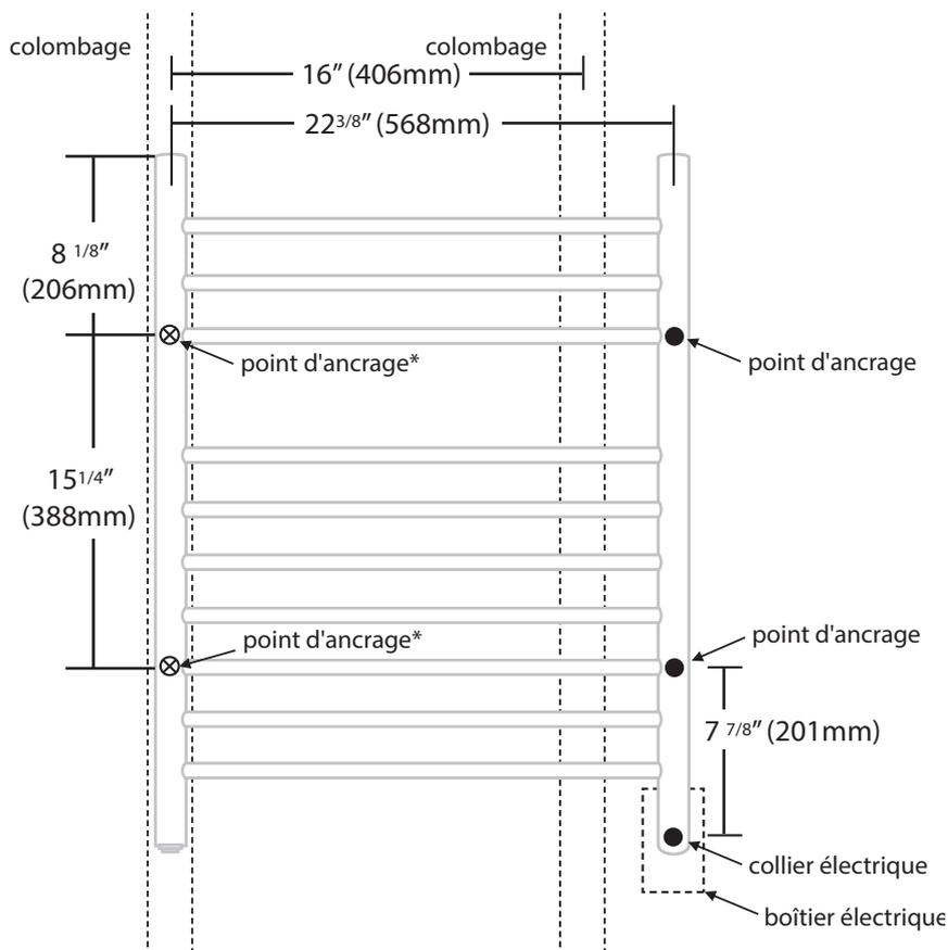
† **Note:** Pour le modèle câblé uniquement, la boîte électrique doit être solidement fixée à un montant. Le modèle enfichable seulement doit être installé à moins de 6 pieds (183 cm) d'une prise de courant correctement mise à la terre. NE PAS utiliser de rallonge.
