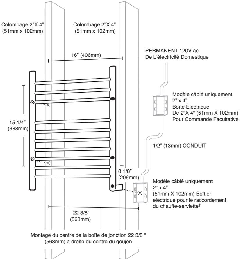
† **Note:** Pour le modèle câblé uniquement, la boîte électrique doit être solidement fixée à un montant. Le modèle enfichable seulement doit être installé à moins de 6 pieds (183 cm) d'une prise de courant correctement mise à la terre. NE PAS utiliser de rallonge.
