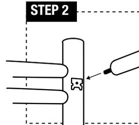
**ÉTAPE 2:** utilisez la vis courte (d) pour fixer le tube sur le petit carré métallique déjà attaché sur la barre verticale à l'arrière du chauffe-serviettes.
