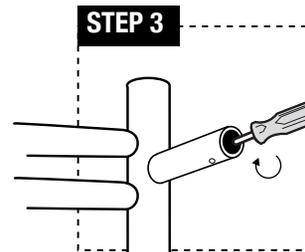
**ÉTAPE 3:** visser la vis courte (d) avec un tournevis. Notez que la vis de réglage du tube (a) doit pointer vers le sol lorsque le porte-serviettes est monté sur le mur. Fixez les trois tubes restant (a) sur les barres verticales en répétant l'étape 1-3.
