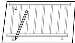
Placez le porte-serviettes chauffant sur la boîte (ou une grande feuille de papier) et posez sur une surface plate avec les tubes de montage orientés vers le bas. Marquez l'emplacement des éléments suivants:
