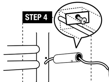
**ÉTAPE 4:** Passez le cordon électrique à travers le tube de montage de la connexion électrique (b) et utilisez la longue vis de montage (e) pour serrer le tube de montage de la connexion électrique sur la barre verticale.
