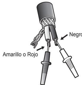
Conecte las sondas a ambos conductores internos y registre la lectura del ohmímetro.
