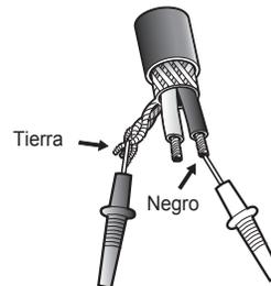
Conecte las sondas tanto al cable del núcleo como al de tierra en el INICIO del cable.
