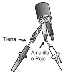
Conecte las sondas tanto al cable del núcleo como al de tierra en el INICIO del cable.
