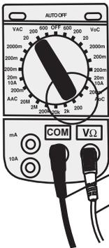
Compruebe el ohmímetro para asegurarse de que contiene pilas nuevas y está ajustado/calibrado a una escala de 0 - 200 antes de realizar cualquier lectura.
