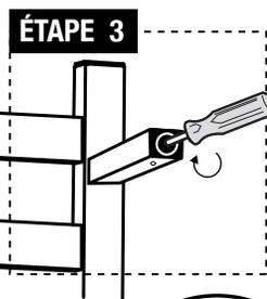
**ÉTAPE 3:** visser la vis courte (c) avec un tournevis. Notez que la vis de réglage du tube (a) doit pointer vers le sol lorsque le porte-serviettes est monté sur le mur. Fixez les trois tubes restant (c) sur les barres verticales en répétant l'étape 1-3.
