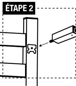
**ÉTAPE 2:** utilisez la vis courte (c) pour fixer le tube sur le petit carré métallique déjà attaché sur la barre verticale à l'arrière du chauffe-serviettes.
