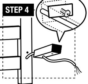
**ÉTAPE 4:** Passez le cordon électrique à travers le tube de montage de la connexion électrique (g) et utilisez la longue vis de montage (h) pour serrer le tube de montage de la connexion électrique sur la barre verticale.
